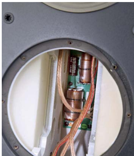
Delningsfiltren som sitter direktmonterade på anslutningspanelen bak innehåller få men väl valda komponenter. Det tyder på att man litat på sina drivelement.
